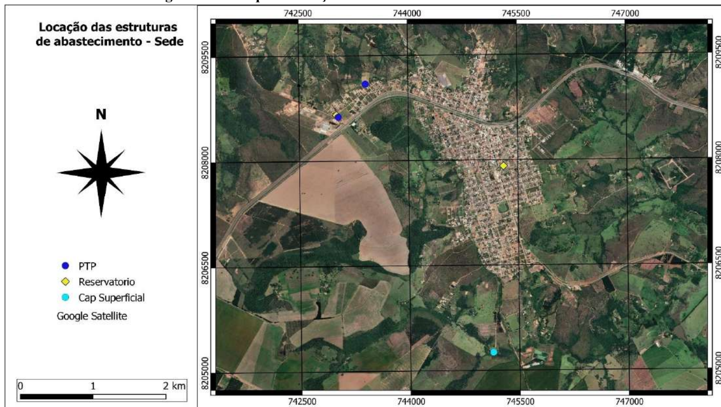
Figura 22 - Croqui de locação das estruturas de abastecimento.
